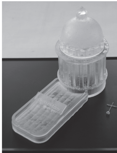
Rys. 8. Złożony z kilku wydrukowanych osobno części model architektoniczny kaplicy grobowej rodziny Wegnerów w Ostaszewie (fot. autor)
