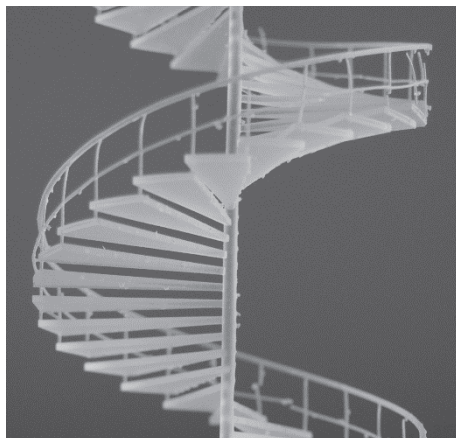
Rys. 4. Fragment wydrukowanego modelu schodów kręconych – widoczne nieplanowane krzywizny, pęknięcia i pozostałości po podporach (fot. autor)
